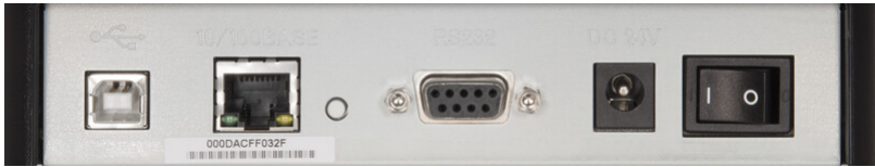
Interfaces LAN, USB y serie incorporadas.
